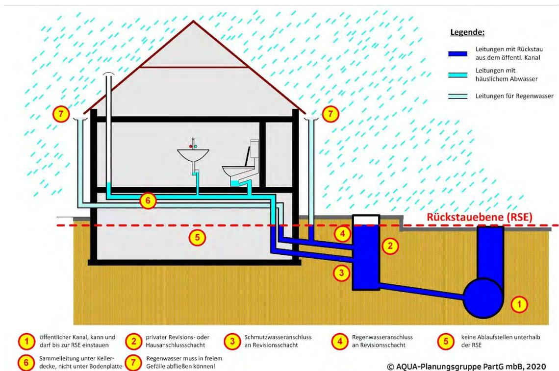
Für Gebäude ohne Keller stellt diese Situation in den meisten Fällen den Normalfall dar. Ein Rückstauschutz wird bei diesen Gebäuden erst dann erforderlich, wenn der Erdgeschossfußboden unterhalb der Rückstaebebene liegt.
