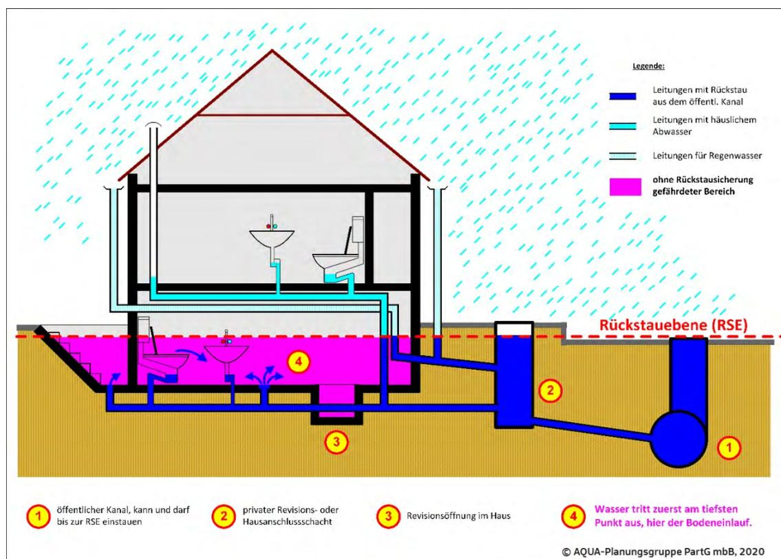
Bei hoher Auslastung des öffentlichen Kanals steigt der Wasserspiegel im Kanalrohr bis über die Höhe des Kellerfußbodens. Wenn es jetzt ungesicherte Abläufe oder undichte Stellen in den Rohren gibt, tritt das Wasser in großen Mengen im Keller aus.
